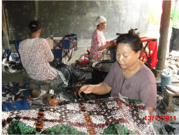
Gambar 4.9. Proses Pemberian malam dengan canting
