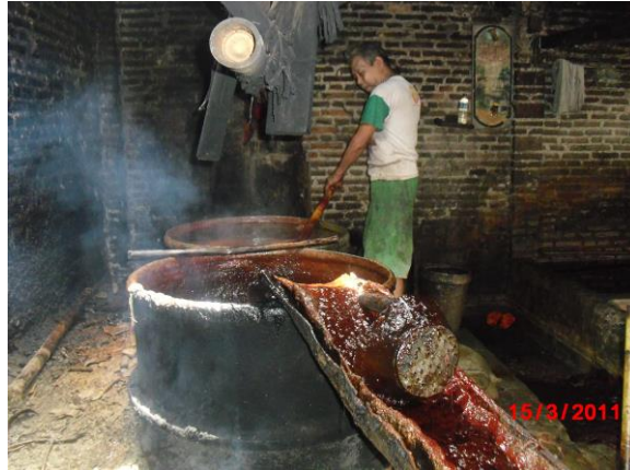
Gambar 4.10. Proses Nglorod Malam
